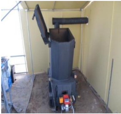
バイオマス加温機
